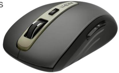
Diese kabellose Maus bietet eine ausgezeichnete Performance und Funktionalität in einem eleganten Design. Die MT350 ist mit einem einzigartigen Multi-Mode Chipsatz ausgestattet, der eine Übertragung über Bluetooth 3.0, Bluetooth 4.0 und eine 2,4 GHz Wireless-Verbindung ermöglicht. Bis zu 3 unterschiedliche Geräte lassen sich gleichzeitig mit der Maus verbinden und der Wechsel zwischen den
